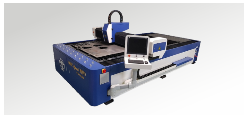
Лазерное оборудование для раскроя листового проката с ЧПУ, мощностью до 3кВт и рабочим столом 1500x3000мм и толщиной резки листа до 20мм (Зед)
